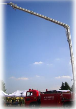
「屈折放水塔車」
